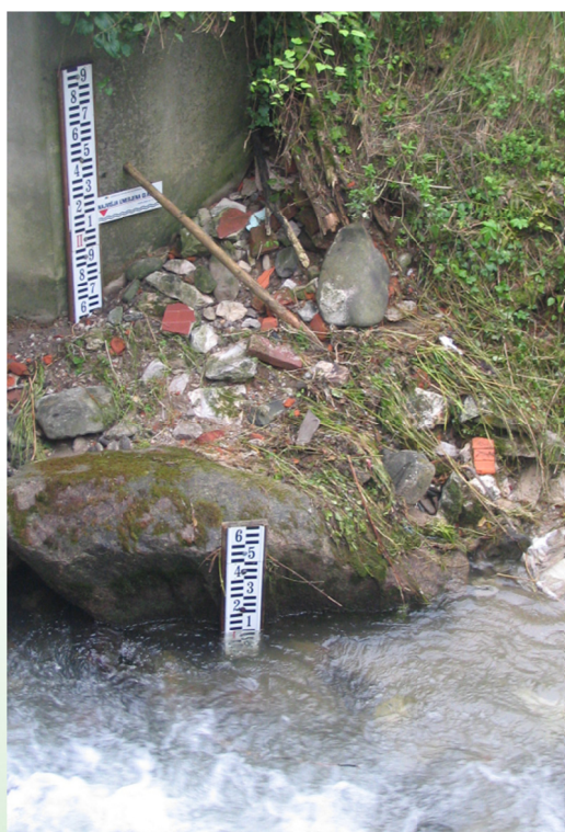
Slika 8: Merilni lati na lokaciji vodomerne postaje Otiški Vrh I – Mislinja (FOTO: G. Novak)
