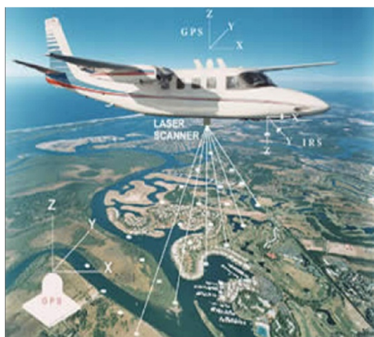
Slika 18: Sistem LIDAR (shematični prikaz snemanja terena z laserjem)
